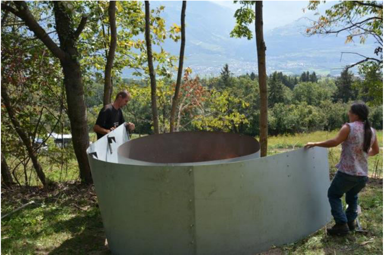
Abb. 12: Einhängen des Aussenmantels zur Optimierung der Verbrennungsdynamik.
