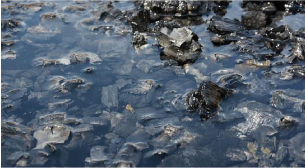
Abb. 14: Kristallklares Quenchwasser ist das beste Zeichen für einen sauberen Pyrolyseprozess.
